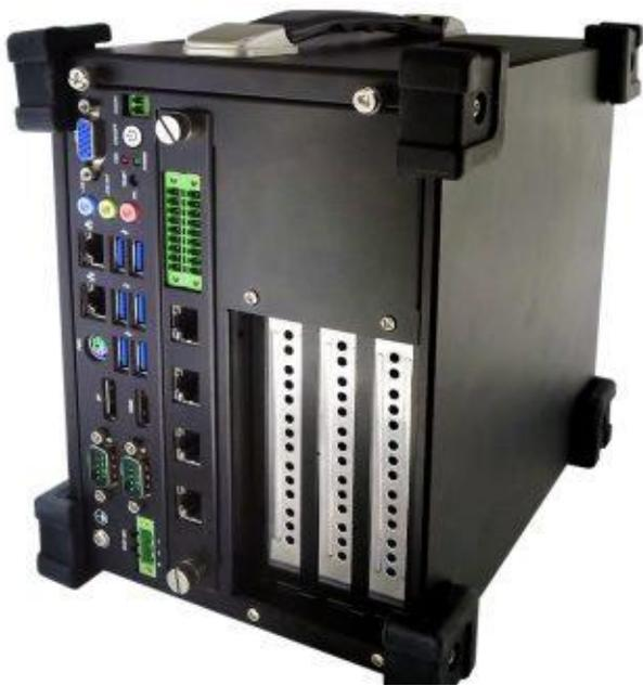
**СПАРКС JW1300** - Малогабаритные промышленный ПК СПАРКС с пассивным охлаждением может использоваться для встраиваемых компьютерных комплексов (банкоматы, платежные терминалы и т.п.), а также для мобильных бортовых систем. Решения СПАРКС являются высокопроизводительными компьютерами с пониженным энергопотреблением, а также предусмотрены различные возможности монтажа корпуса устройства. Для каждой модели предлагается несколько базовых конфигураций.
